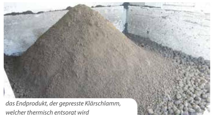
das Endprodukt, der gepresste Klärschlamm, welcher thermisch entsorgt wird
